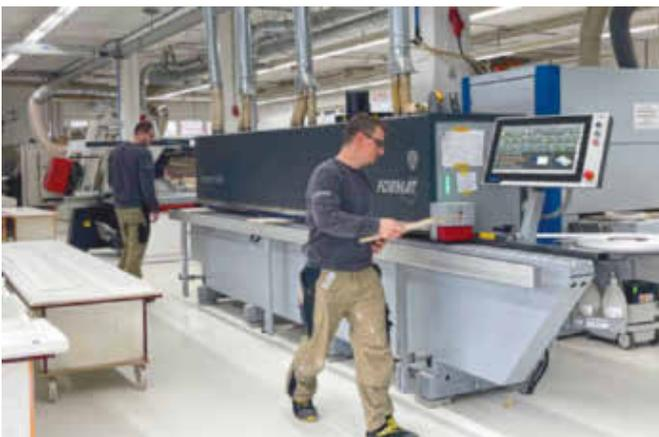
*Die Kantenleimmaschine Tempora F800 kann zeitlich parallel zur Nestingbearbeitung bestückt werden.*
