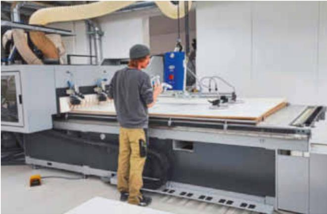
*/ Mit einem Vakuum-Hebegerät werden die Platten manuell vom Stapel auf dem Maschinentisch der Nesting-CNC abgelegt und durch Anschlagzylinder positioniert.*
